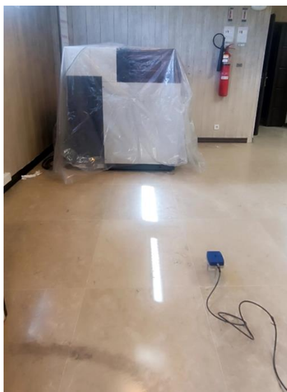
شکل ۲-۲- نمایی از سنسور سه مولفه دستگاه لرزه نگار ماکرومیت در فاصله یک متری از دستگاه XRF.
