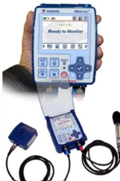
شکل ۱-۱- نمایی از دستگاه مایکرومیت به همراه سنسورهای ژئوفون و میکروفن.
