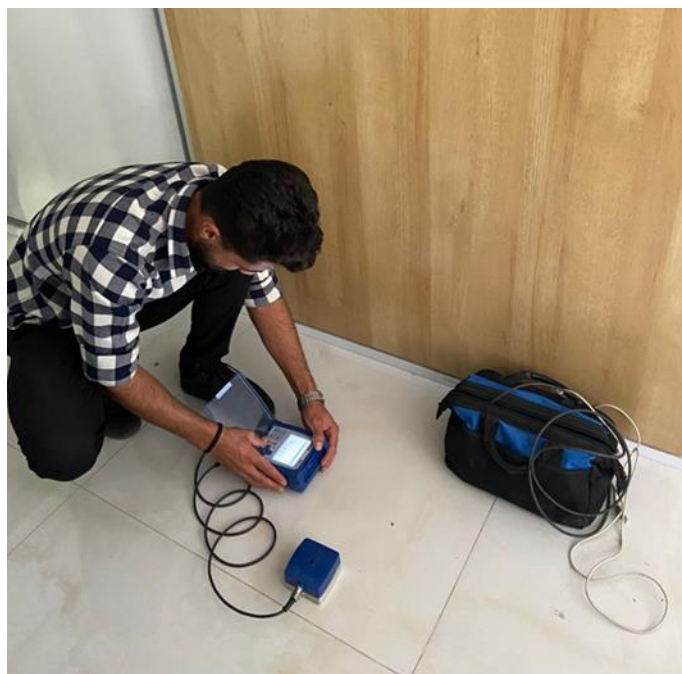
شکل ۱-۲- تصویر اپراتور در حال تنظیم دستگاه میکرومیت برای برداشت.
