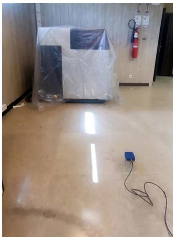
شکل ۵-۴- نمایی از سنسور سه مولفه دستگاه لرزه نگار ماکرومیت در فاصله یک متری از دستگاه XRF.
