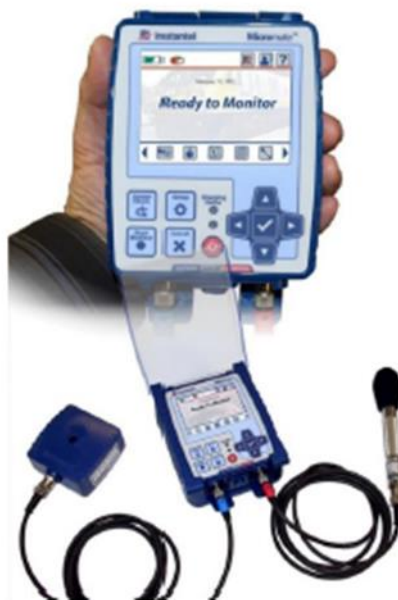
شکل ۵-۷- نمایی از دستگاه مایکرومیت به همراه سنسورهای ژئوفن و میکروفن.
