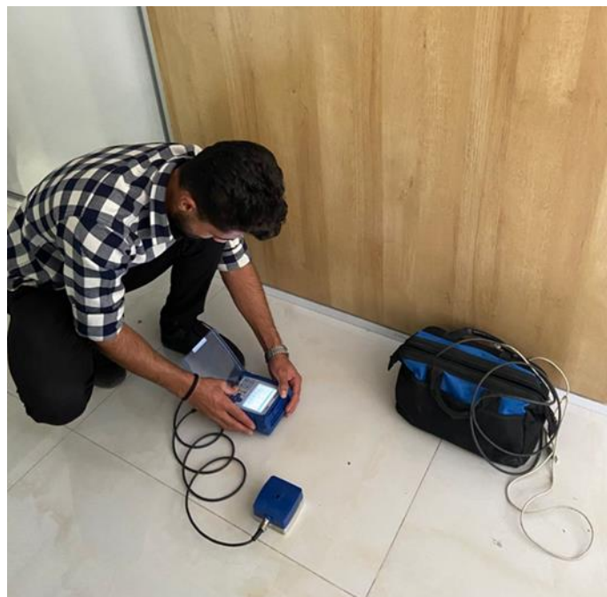
شکل ۵-۳- تصویر اپراتور در حال تنظیم دستگاه مایکرومیت برای برداشت.
