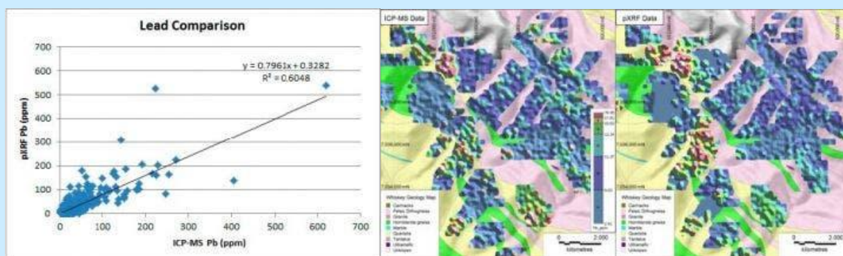
شکل ۳- مقایسه‌ای مقدار سرب (Pb) اندازه‌گیری‌شده با دو روش pXRF و ICP-MS را نشان می‌دهد
