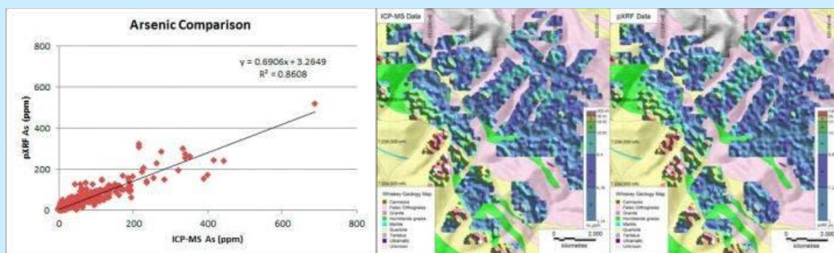
شکل ۱- مقایسه‌ای مقدار آرسنیک (As) اندازه‌گیری‌شده با دو روش pXRF و ICP-MS را نشان می‌دهد
