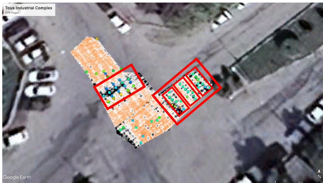
شکل ۴- نمایش آنومالی های متعدد مشکوک به وجود تاسیسات آب، گاز و مخازرات در عمق های حدودی ۰,۳ الی ۱,۲ متری، این محدوده یکی از حساس ترین زون های عملیات بوده است.
