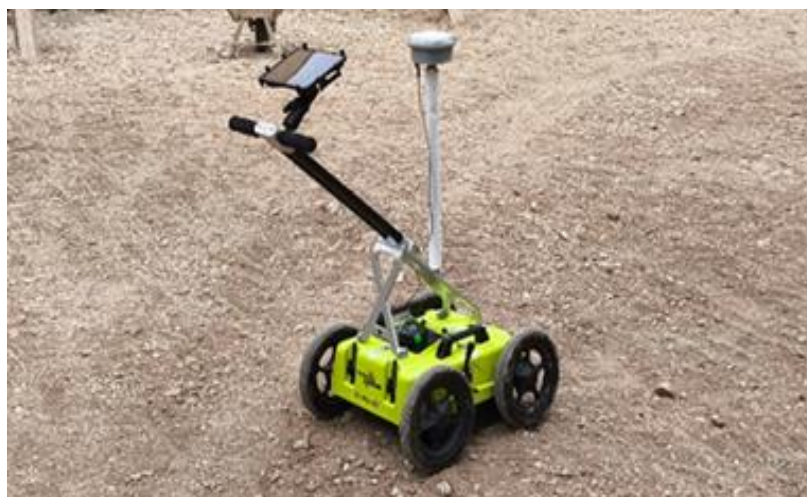
شکل ۲- دستگاه GPR ایمپالس رادار مدل PinPointR به همراه GPS مولتی فرکانس.
