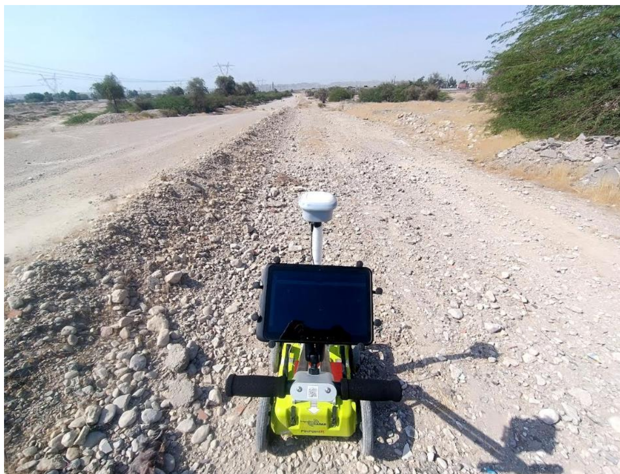
شکل ۱- نمایی از دستگاه PinPointR و محل انجام پروژه.
