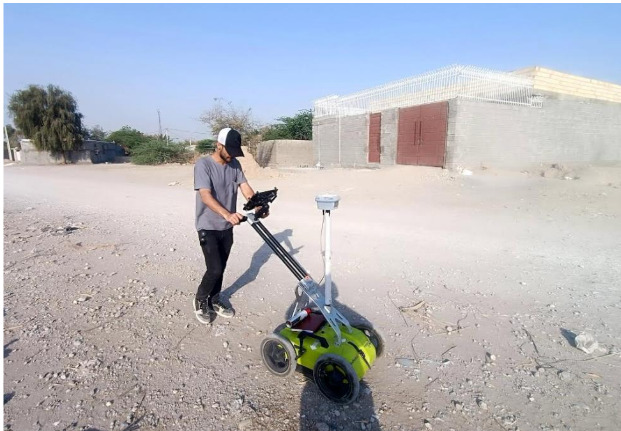
شکل ۳- کارشناس در حال برداشت داده ژئورادار.
