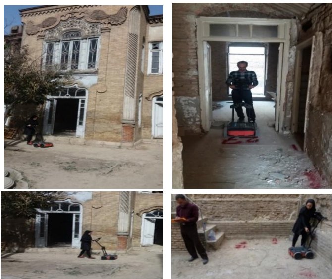
شکل ۳-۴- پروژه ژئورادار محدوده خانه مینایی واقع در کوچه کریمی طیب.
