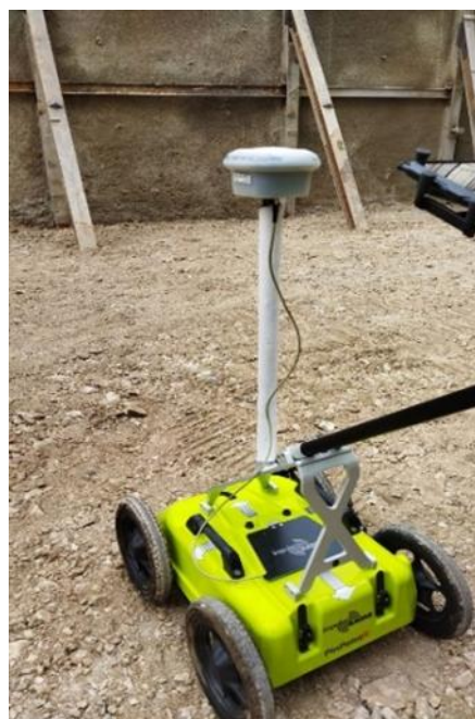
شکل ۳-۵- GPS مولتی فرکانس متصل به دستگاه.
