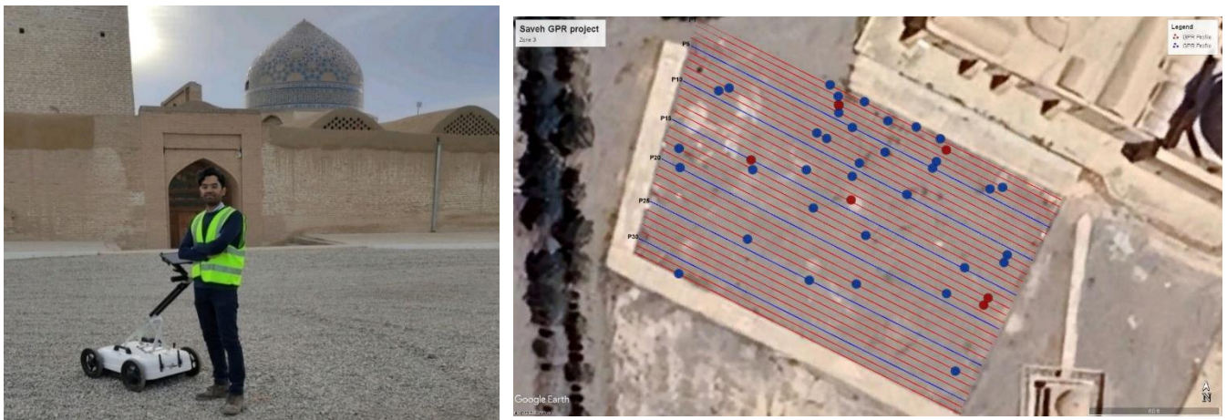
شکل ۴-۱۵- پروژه ژئورادار مسجد جامع شهر ساوه.
