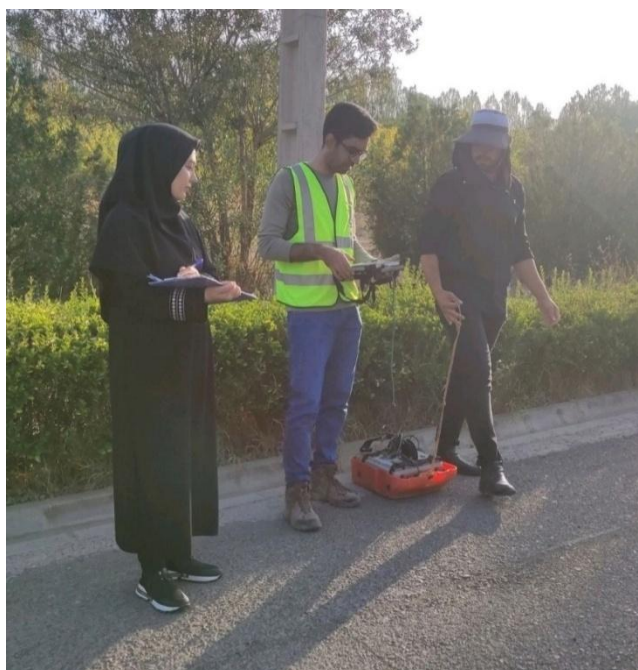
شکل ۳-۳- تصویر دستگاه دو فرکانسه مدل DF برند GSSI آمریکا.
