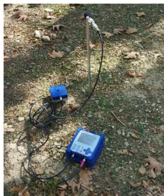
شکل ۴-۲- نمایی از دستگاه Micromate ساخت شرکت Instantel.
