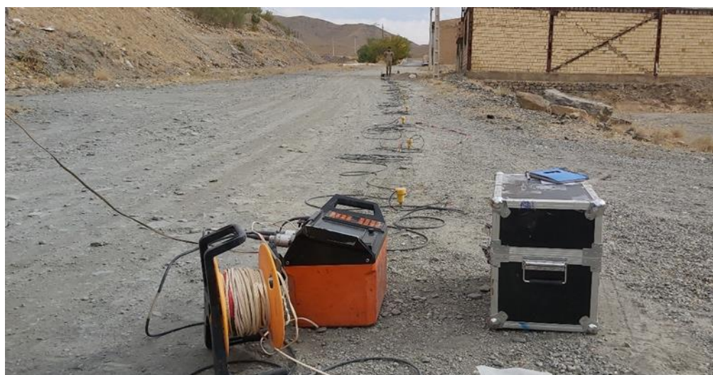
شکل ۴-۱- عملیات لرزه نگاری با استفاده از دستگاه ABEM ۲۴ کاناله.
