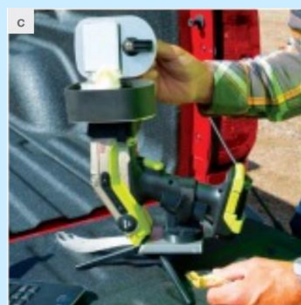
شکل ۱- (a) دستگاه آنالایزر دستی Niton XL5 Plus؛ (b) نمایش نتایج آنالیز عنصری سنگ معدن حاوی روی، سرب، مس و نقره روی صفحه دستگاه؛ (c) انجام آنالیز نمونه با استفاده از پایه آزمایشگاهی Thermo Scientific XL5 Mini Test Stand.
