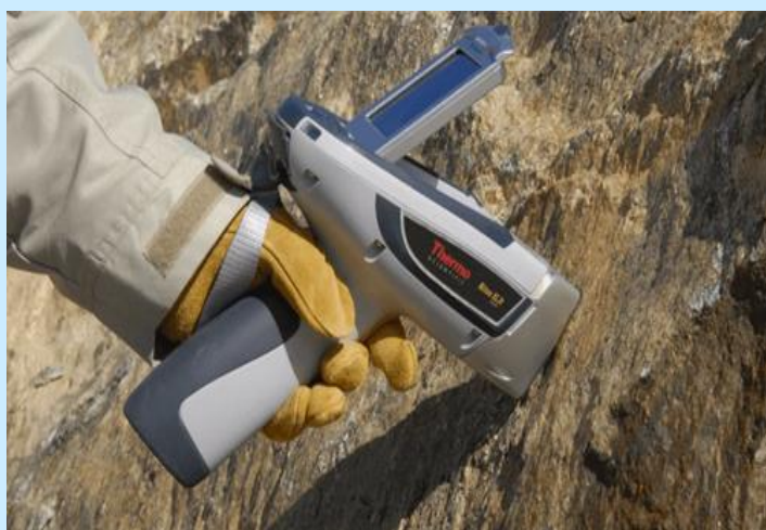
شکل ۱- (a) نمونه ای از نتیجه آنالیز یک نمونه پرعیار کلتان (b) دستگاه XL3t GOLDD+.
