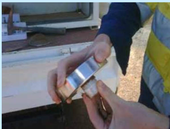
شکل (۱) نمونه پالپ RC به‌طور ملایمی فشرده می‌شود تا سطحی صاف برای انجام آنالیز فراهم شود.
