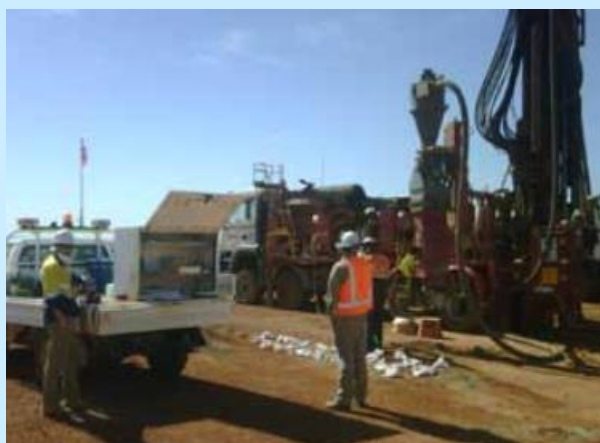
۳۵ نمونه حفاری دورانی معکوس (RC) در محل با استفاده از دستگاه XRF مدل Niton XL3t از شرکت Thermo Scientific آنالیز شدند
