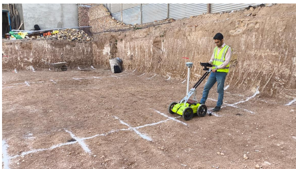
شکل 3- کارشناس در حال برداشت داده ژئورادار.
