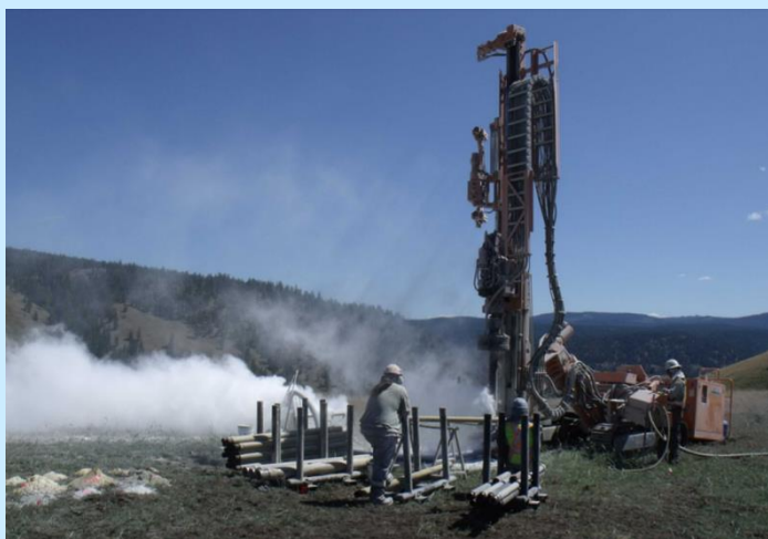
شکل ۲: عملیات مغزه گیری برای مطالعه کانسارهای مس پورفیری در کانادا.
