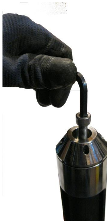
شکل ۴-۶: باز کردن پیچ بالانس پکر سوند
