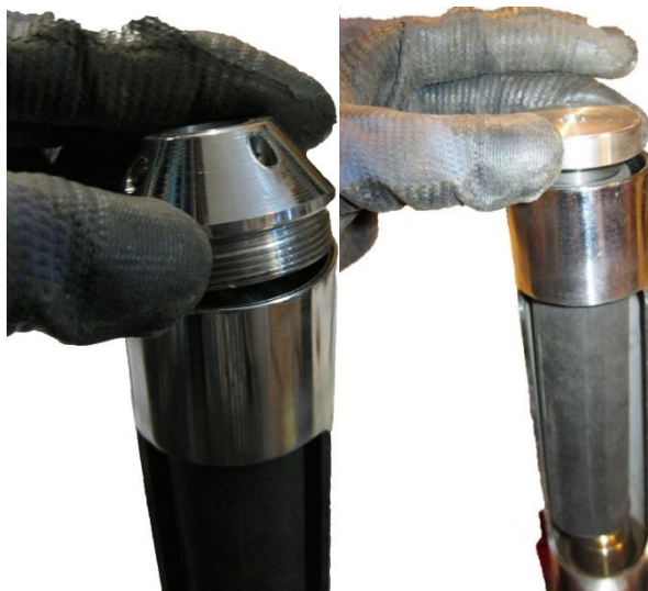
شکل ۶-۱۳: قرار دادن تیوپ و لوله داخل محفظه پکر
