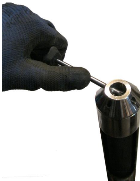
شکل ۶-۵: باز کردن درب کپ پایین سوند
