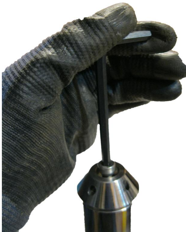
شکل ۶-۱۵: سفت کردن پیچ بالانس پکر و تیوپ
