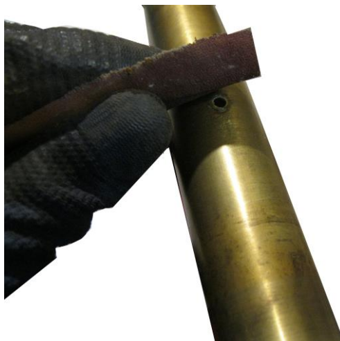
شکل ۶-۷: تمیز کردن سطح لوله برنجی با سمباده
