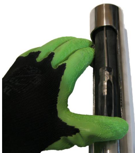
شکل ۶-۶: خلاص کردن تیوپ پک شده به پکر
