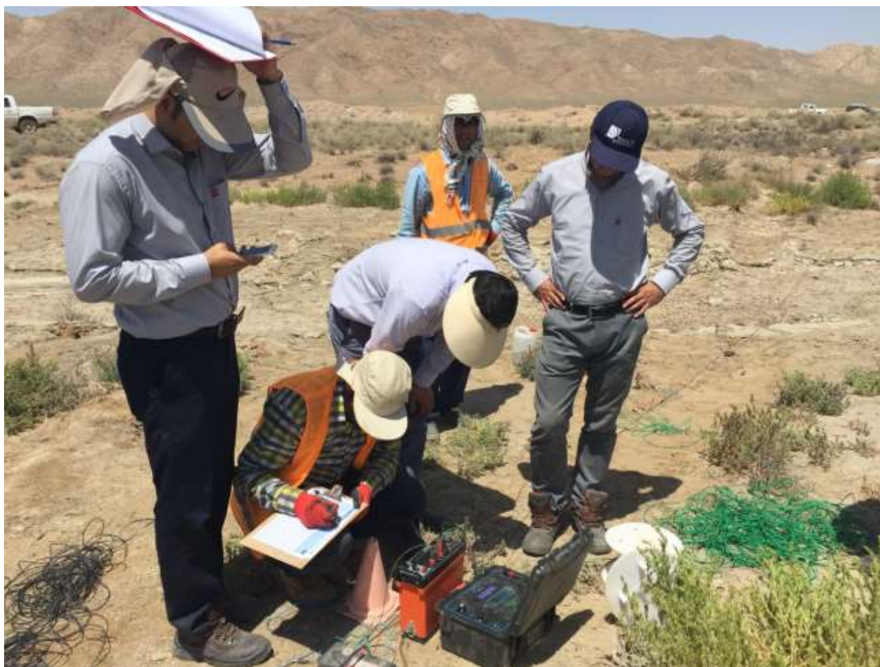
شکل 2 تصویری از برداشت همزمان مقاومت ویژه با دو دستگاه RS888q و ABEM در معدن آهن گل گهر (تاریخ ۹۶/۰۴/۱۴)
