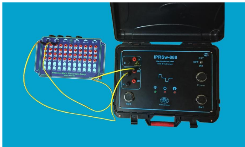
شکل ۱۹- نحوه اتصال PMS-66 به دستگاه IPRSw-888
