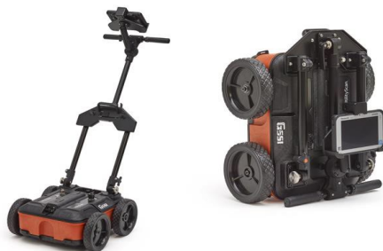
شکل ۱. شمایی از دستگاه GPR آنتن ۳۵۰ مگاهرتز مدل UtilityScan.
