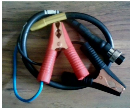
شکل ۸ - کابل اکسترنال باتری
